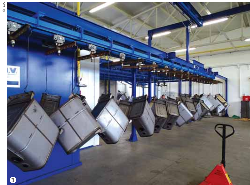
Figura 3: Serbatoi in attesa dell'ingresso nel tunnel di pretrattamento.
